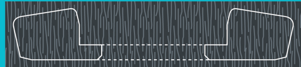
Fibrado de engranaje cónico partiendo de barra comercial forjada
